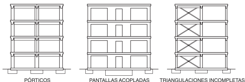
Figura 3.4. Ejemplos de organizaciones estructurales que permiten un valor del coeficiente de comportamiento por ductilidad \mu = 4
