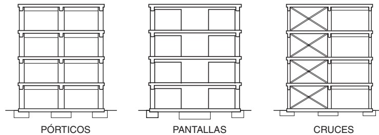
Figura 3.5. Ejemplos de organizaciones estructurales que permiten un valor del coeficiente de comportamiento por ductilidad \mu = 3
