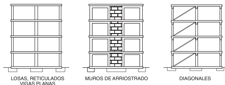
Figura 3.6. Ejemplos de organizaciones estructurales que permiten un valor del coeficiente de comportamiento por ductilidad \mu = 2
